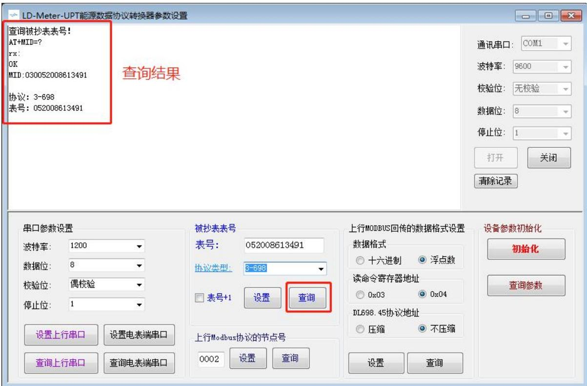
6.5 上行通道 RS485 Modbus RTU 地址 ID 的设置，可设置、查询
