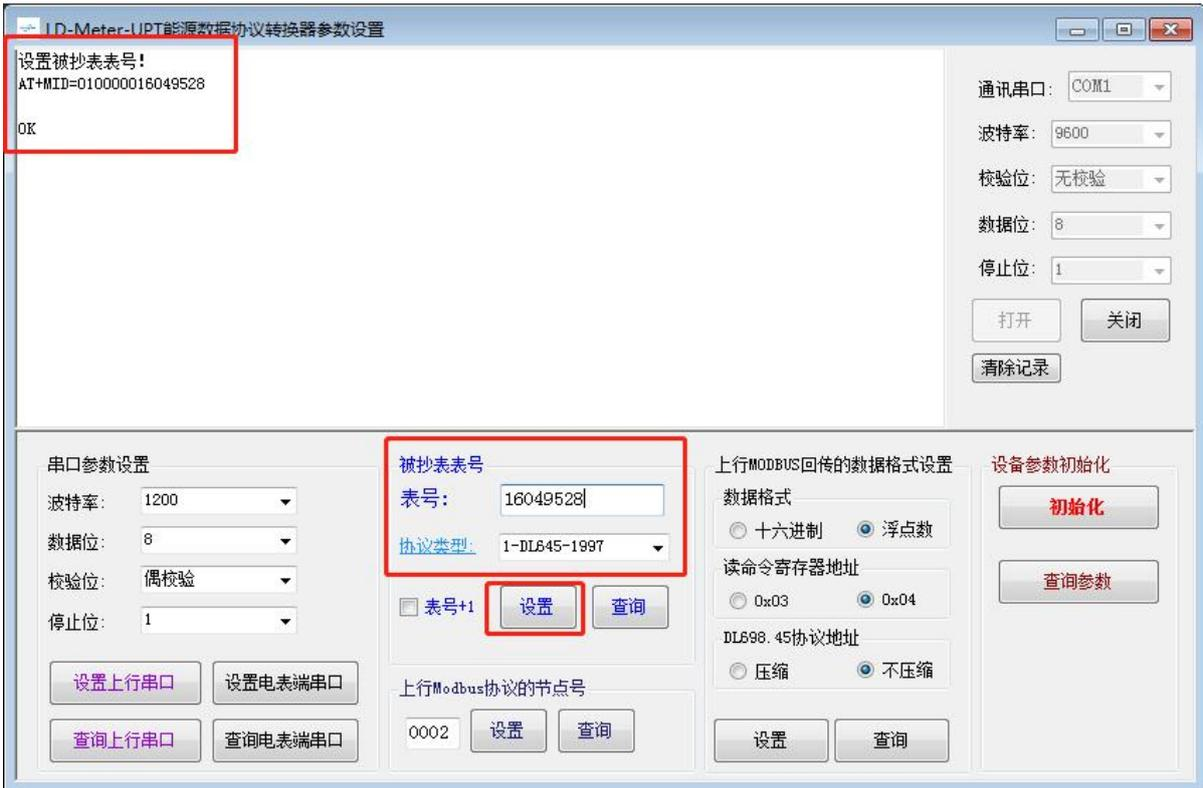
6.4.4 查询被抄表的表号及智能电能表通信协议，查询设置是否与现场电能表标注通信协议一致，点击“**查询**”按钮
