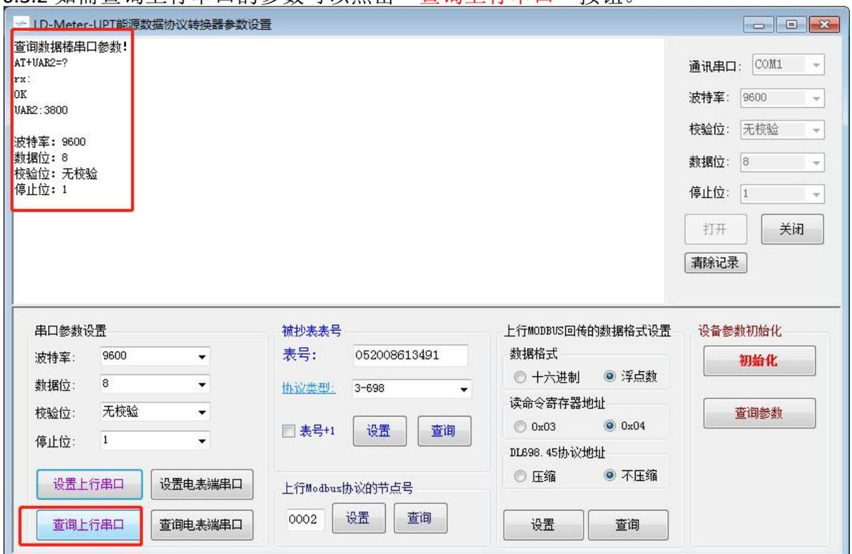
6.3.3 设置下行通道 RS485 串口参数（红外抄表器 RS485 通信接口参数，红外抄表器默认参数：**1200,E,8,1**，这个参数取决于智能电能表上红外通讯口参数）
